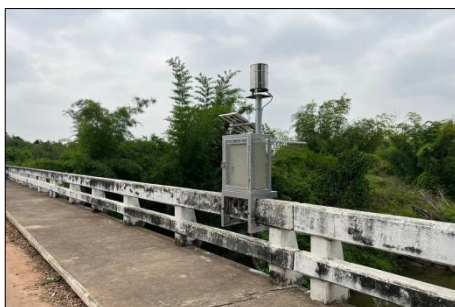
รูปที่ 1-24 ระบบโทรมาตรตรวจวัดระดับน้ำ (ท้ายน้ำ)
