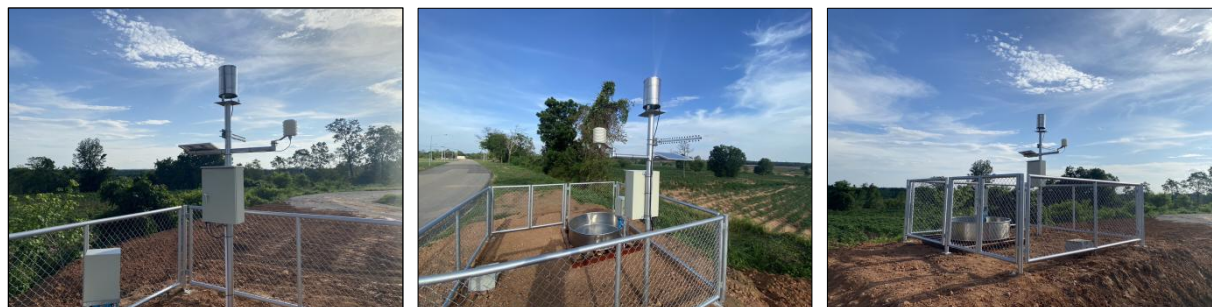
รูปที่ 1-25 ระบบโทรมาตรตรวจวัดข้อมูลทางอุตุนิยมวิทยา
