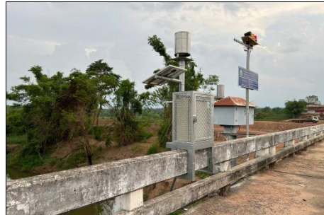
รูปที่ 1-22 ระบบโทรมาตร ตรวจวัดระดับน้ำ (เหนือน้ำ)
