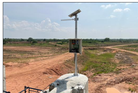
รูปที่ 1-23 ระบบโทรมาตรตรวจวัดระดับน้ำ (กลางน้ำ)
