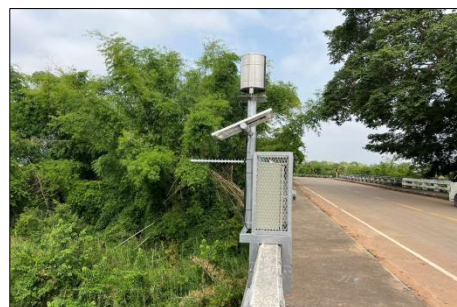
รูปที่ 1-24 ระบบโทรมาตรตรวจวัดระดับน้ำ (ท้ายน้ำ)
