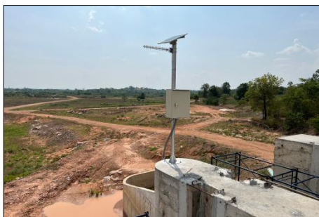
รูปที่ 1-23 ระบบโทรมาตรตรวจวัดระดับน้ำ (กลางน้ำ)
