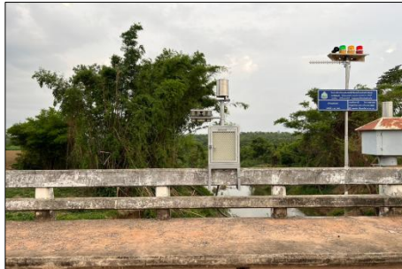
รูปที่ 1-22 ระบบโทรมาตร ตรวจวัดระดับน้ำ (เหนือน้ำ)
